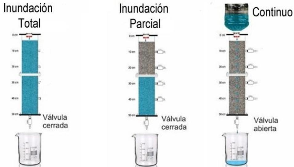
Fig. 15 Diagrama de configuraciones de los filtros domésticos: Inundación Total, Inundación Parcial y Continuo.
