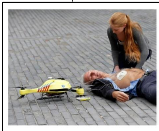
Figura 10. Prototipo de dron ambulancia capaz de llevar un desfibrilador en un tiempo récord
