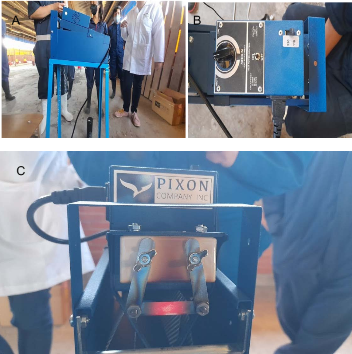
Figura 10: Despicatora Lyon Super utilizada para el tratamiento de pico con cuchilla caliente. A) Vista lateral, B) Perilla para control de temperatura, C) Cuchilla al rojo vivo.
