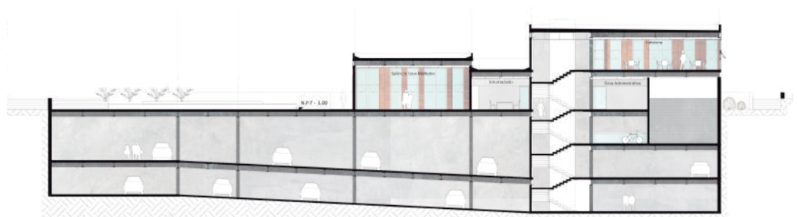
Fig. 75 Corte Transversal Edificio Dos
