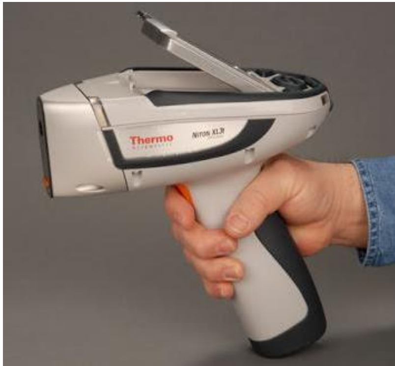
Figura 5. 2046 Analizador de FRX portátil (modelo NITON X-L3t). Tomado Niton, 2010.
