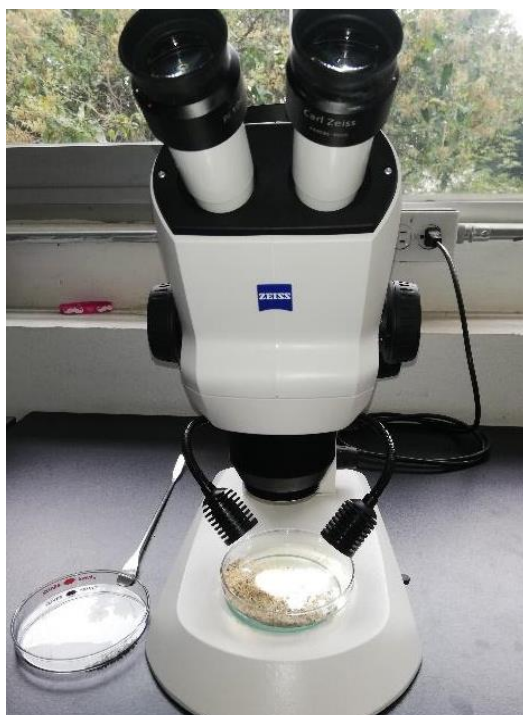
Figura 5. 537. Utilización del microscopio estereoscópico modelo Carl Zeiss, para la separación de cuarzo.
