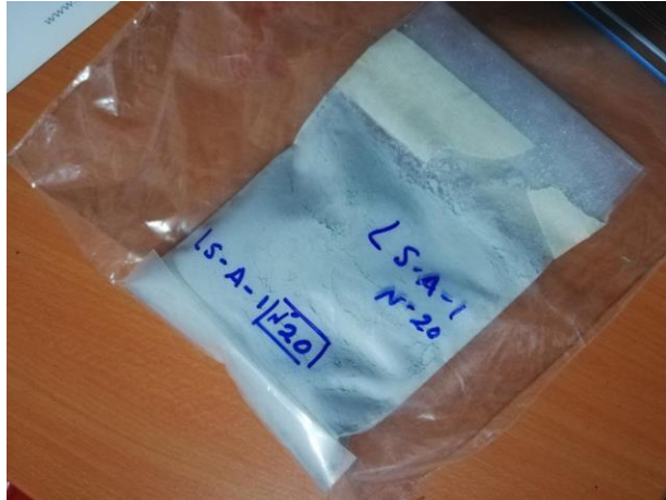
Figura 5. 780 Trituración de muestras de cuarzo, arenas, arcillas y evaporitas en la pulverizadora del Instituto de Geofísica UNAM. Muestra pulverizada de evaporita LS-A-1.
