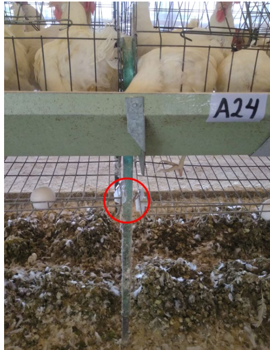
FIGURA 5. Ubicación de los dos dispositivos Ogawa (NH 3 y NO x ) en el sistema de jaulas convencionales.
