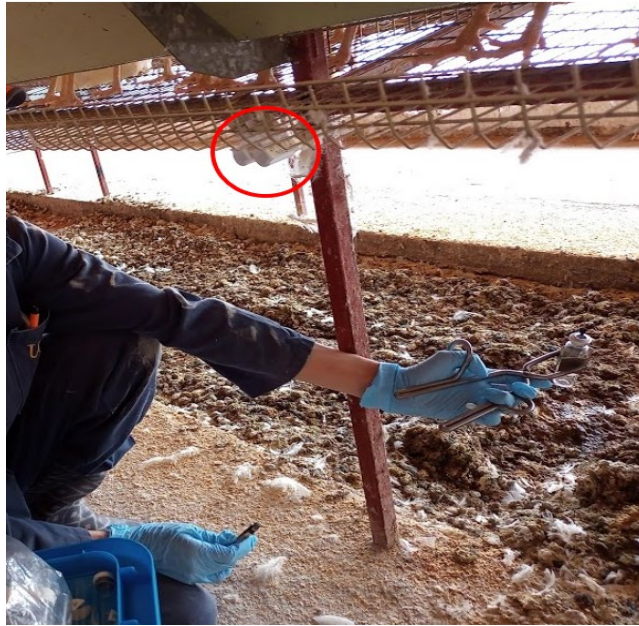
FIGURA 10. Ubicación de los dos dispositivos Ogawa ( \text{NH}_3 y \text{NO}_x ) en el sistema de jaulas enriquecidas.
