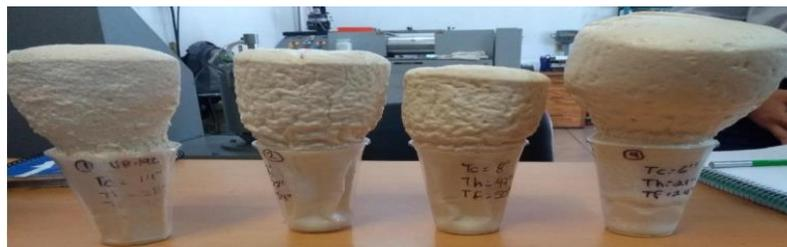
**Figura 26.** Comparación de las espumas 1 (formulación original) hasta la 4 (V-402).
