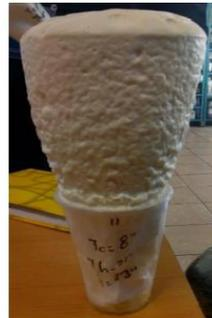
**Figura 30.** Espuma 11 preparada con Inox y Curitane 52
