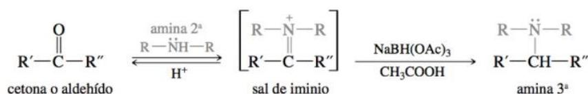
**Figura 8.** Esquema general de síntesis de aminas terciarias.
