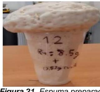
**Figura 21.** Espuma preparada con Inox y polirol multifuncional.
