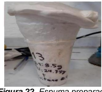
**Figura 22.** Espuma preparada con Inox y el doble de polirol R-330.
