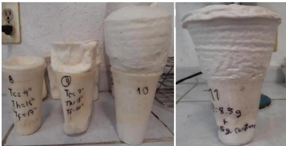
**Figura 20.** Espumas preparadas con Inox.
