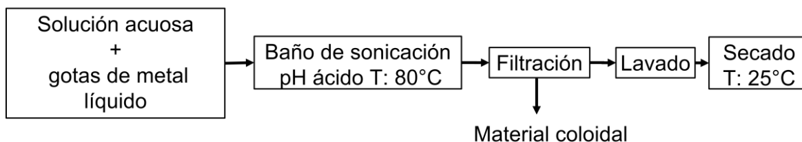
Figura 14. Síntesis por sonicación asistida por reemplazo galvánico de metal líquido
