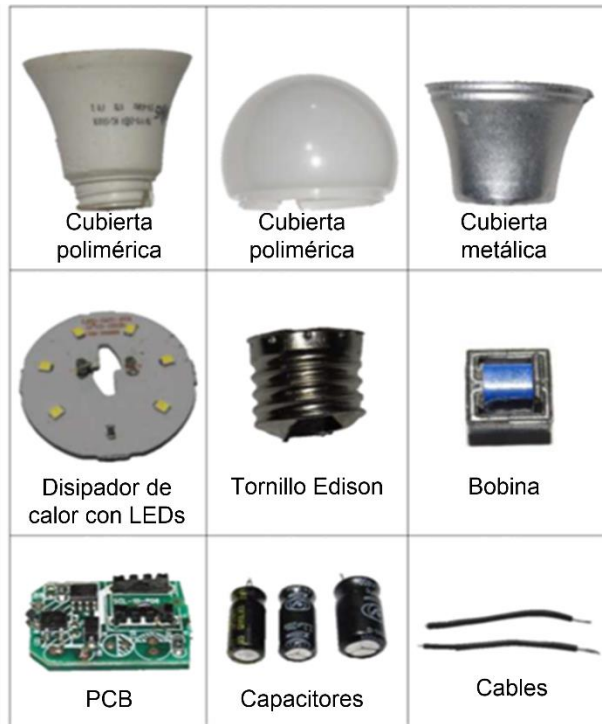
Figura 7. Componentes principales de las lámparas LED
