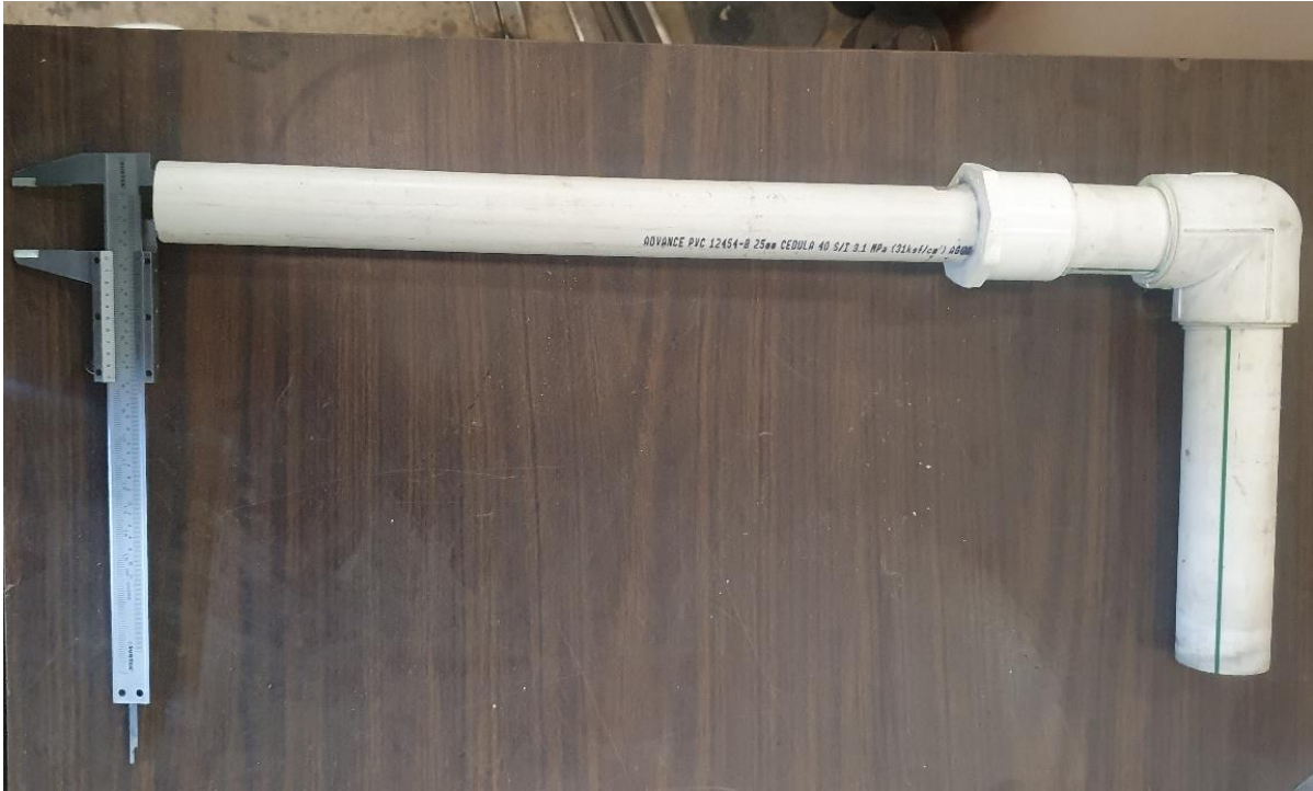
Figura 18. Buza construida con tubo PVC para el presente trabajo
