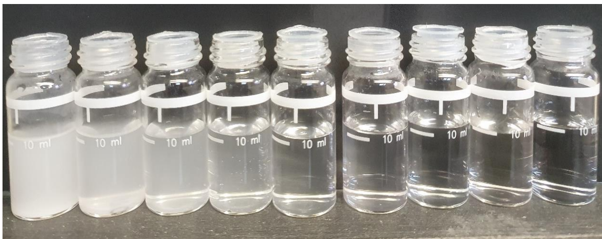
Figura 21. Patrones preparados para realizar la curva de calibración utilizada en la técnica de turbidimetría
