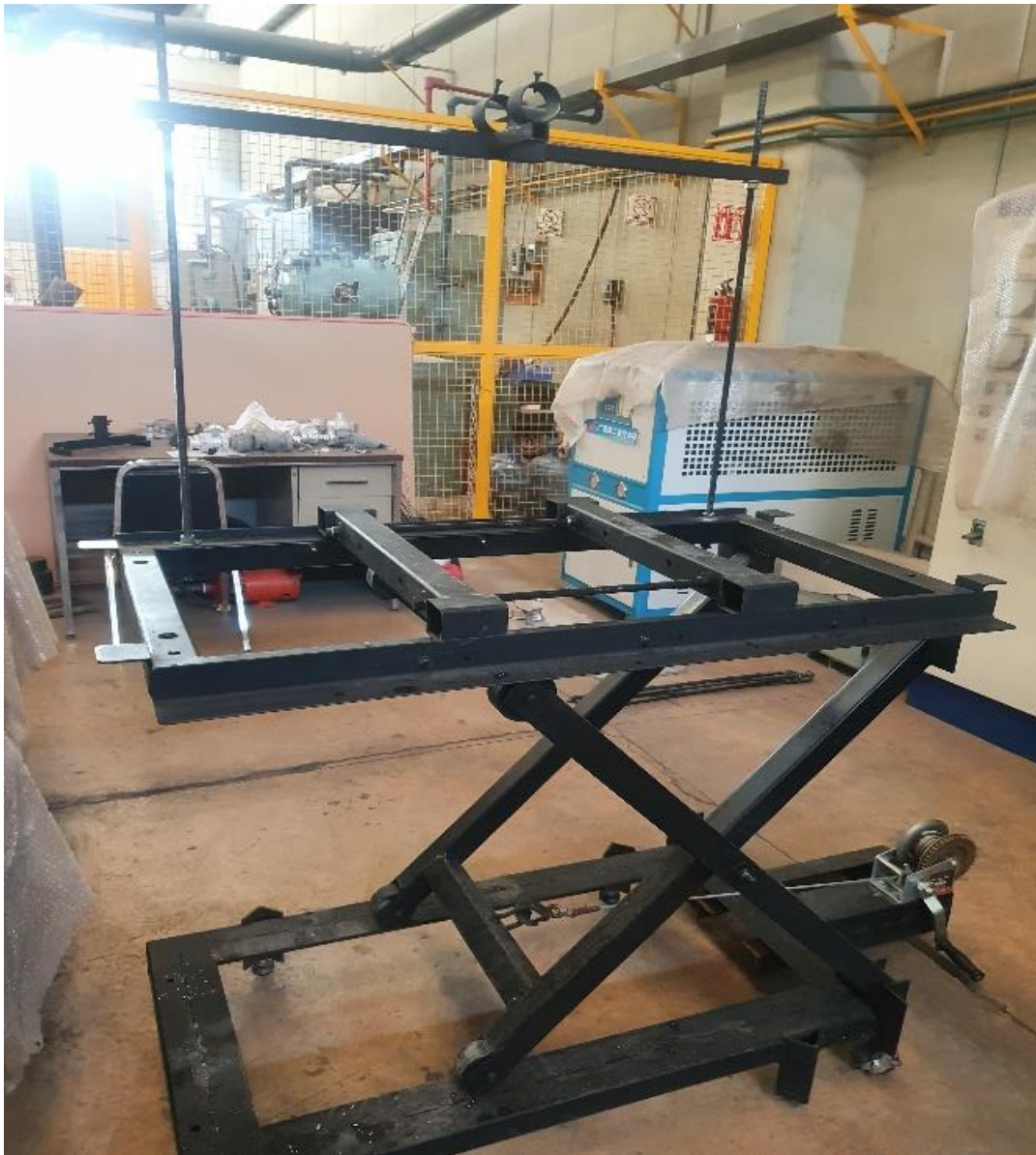
Figura 16. Mesa elevadora con estructura para sostener la conexión manguera-buza
