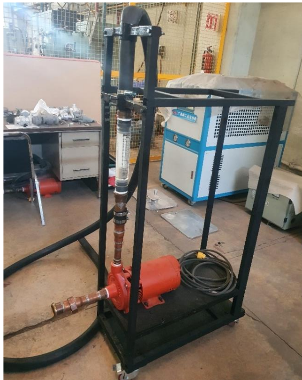
Figura 15. Base para la bomba y el rotámetro
