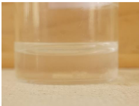
Figura 3.12. Agua con ligero asiento de microbiota de acuerdo con la norma ASTM D6002-96, utilizada para las pruebas de degradación hidrolítica.
