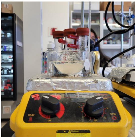
Figura 3.20. Reactor utilizado para las reacciones de copolimerización en suspensión vía radicales libres sin iniciador de P(MMA-co-GMA) utilizando un NADES de B:Gly.
