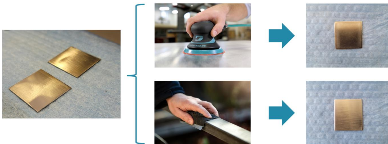
Figura 3.14. Esquema del tratamiento de desbaste en sustratos de acero AISI 304, utilizando una técnica de lijado orbital y lijado perpendicular. a) Sustratos de acero AISI 304, b) técnica de lijado orbital, c) técnica de lijado perpendicular, resultado d) del lijado orbital y e) del lijado en líneas perpendiculares en el sustrato metálico
