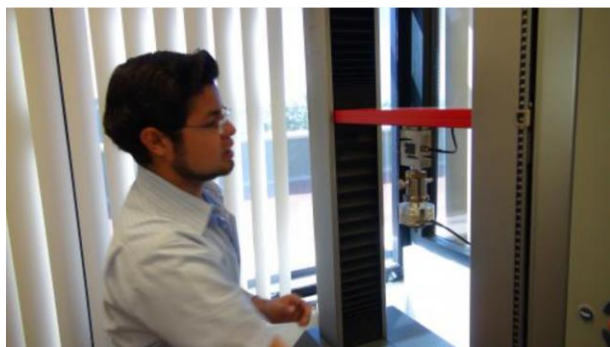
Figura 3.11. a) Máquina de pruebas mecánicas Zwick/Roell Z005 del Laboratorio Nacional de Caracterización de Materiales (LaNCaM) del CFATA-UNAM. b) Probeta utilizada para las pruebas de tensión para la norma ASTM D638, todas las distancias mostradas se encuentran en unidades de milímetros [mm].
