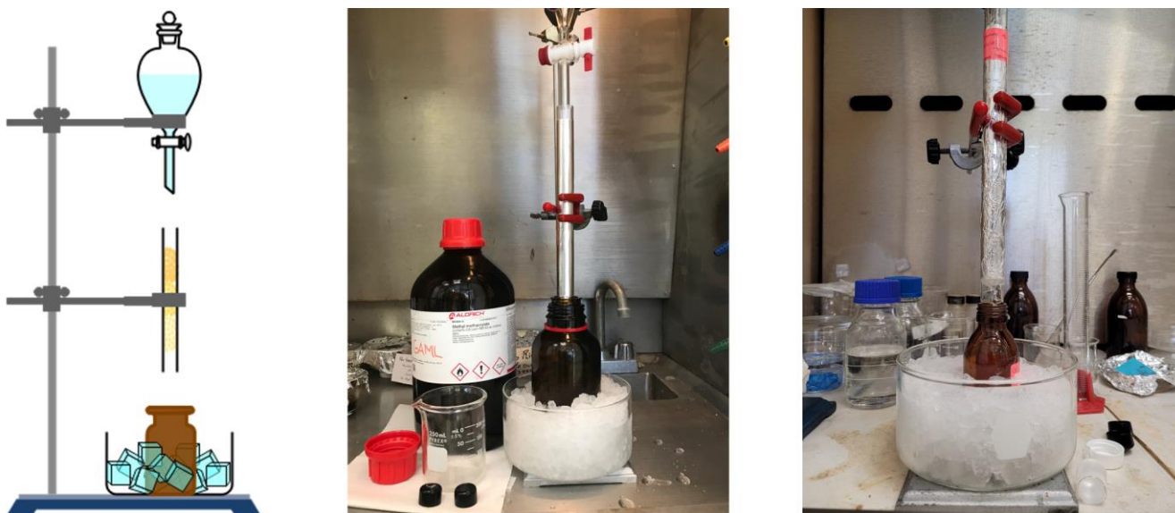
Figura 3.2. a) Esquema para la remoción del inhibidor 4-metoxifenol. Montaje experimental de la remoción del 4-metoxifenol del b) MMA y del c) GMA.
