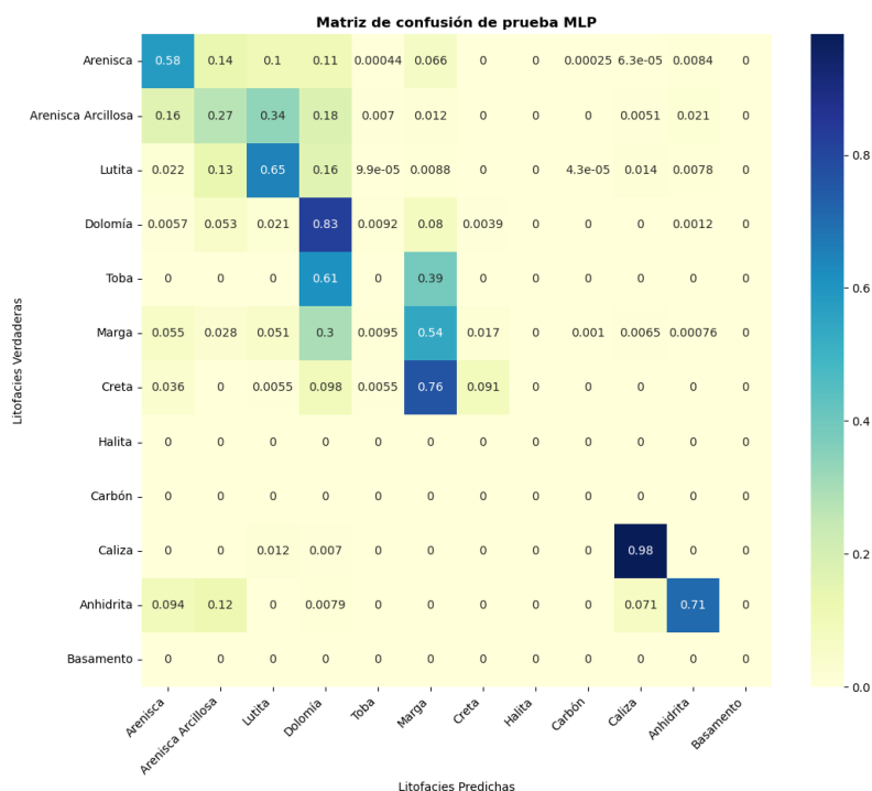
Figura 6.17: Matriz de confusión obtenida para los datos de prueba por un MLP entrenado con el conjunto de datos FORCE.
