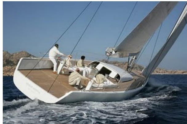
Imagen 10. Velero con casco de fibra de carbóno (B60 Sloop).
