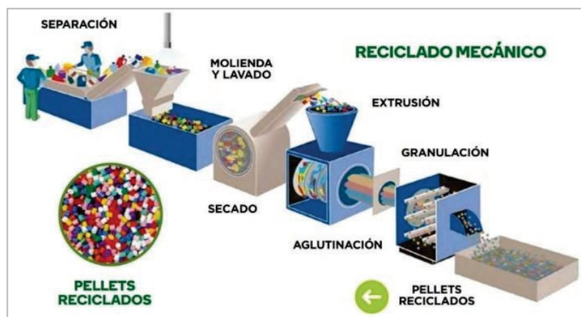
Figura 5.- Proceso de reciclado mecánico por medio de extrusora; (Plabs 3D-Impresión 3D, 2022).
