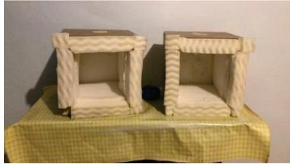
Figura 28.- Cajas elaboradas a base de MDF para la prueba de acústica.
