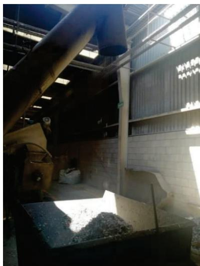
*Figura 81.- Proceso de triturado de plástico.*
