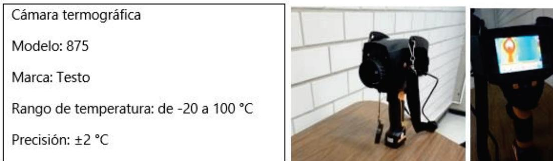
Figura 44.- Cámara termográfica.
