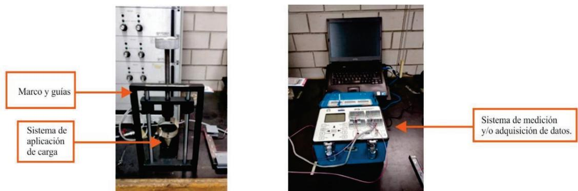
Figura 51. Equipo para prueba de relajación de esfuerzos.
