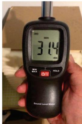
Figura 30.-Sonómetro LCD marca GENERIC utilizado para la prueba.
