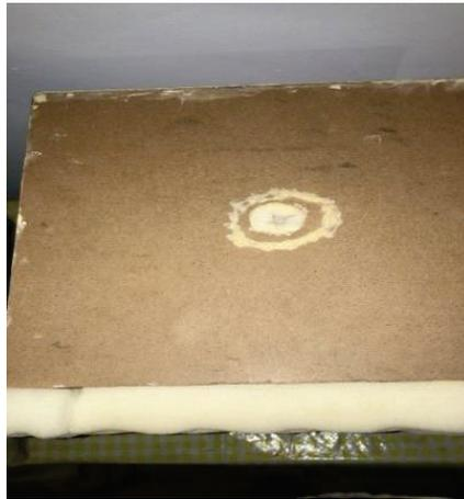
Figura 29.- Perforación hecha a caja de MDF para ingresar el sonómetro.
