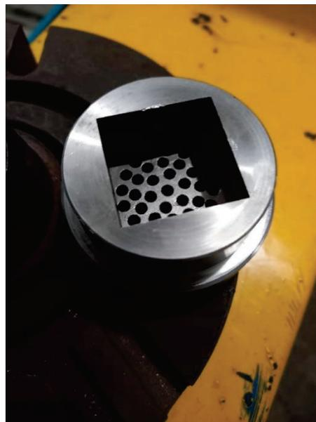
*Figura 91.-Dado de acero para método de transformación de plástico por extrusión.*
