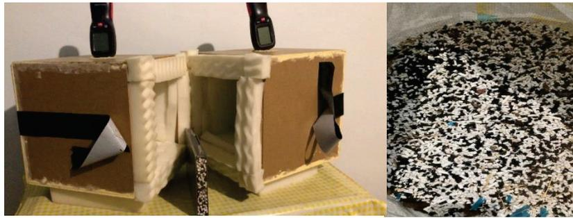
*Figura 37.- Cajas de MDF con una placa de PVC rellena de plástico de reciclaje.*
