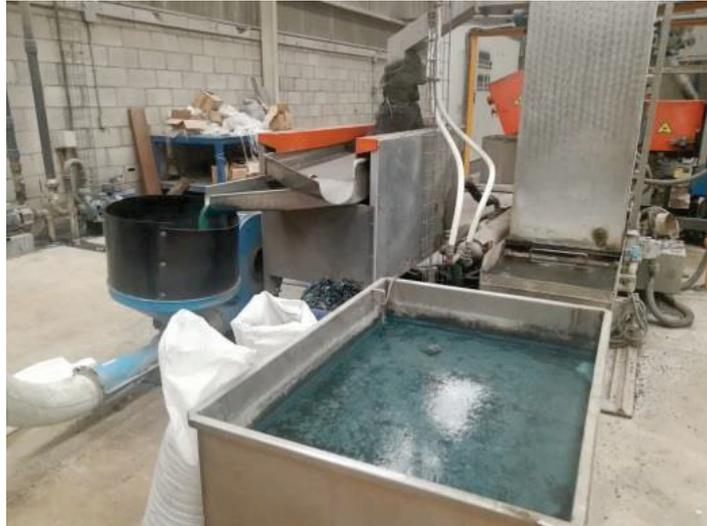
Figura 84.- Proceso de lavado de pellet.
