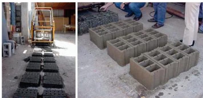
*Figura 10.- Ladrillos elaborados con plástico de reciclaje; (Gaggino, 2008).*
