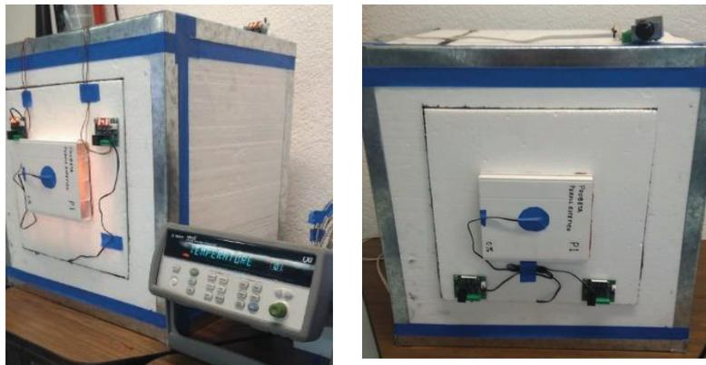
Figura 42.- Armado de cámara adiabática.
