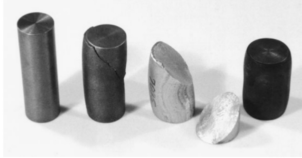
Figura 2.8: Muestras de compresión de metales (de izquierda a derecha): muestras sin ensayar y muestras ensayadas de fundición gris, aleación de aluminio 7075-T651 y acero laminado en caliente AISI 1020. Los diámetros antes de la prueba eran de aproximadamente 25 mm, y las longitudes de 76 mm. [32]
