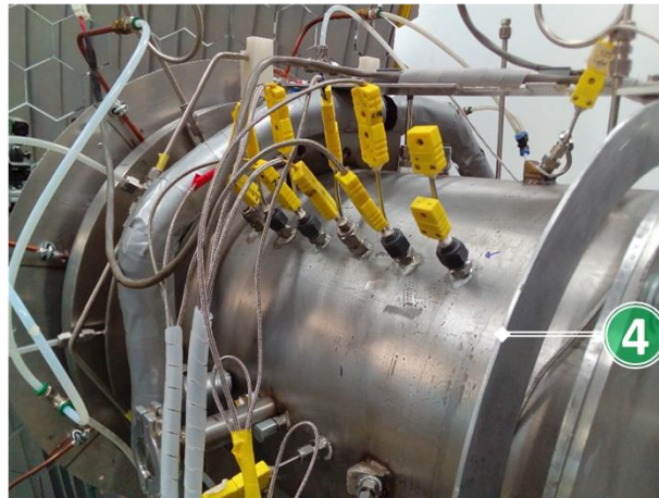
Figura 3.10| Figura superior: Sensores e temperatura en el interior del aislante (TC-1 – TC-6), salida de gases (TA-1 – TA-5), superficie del aislante (SC-1 – SC-4), cavidad (1), absorbedor (2) y aislante (3). En la Figura inferior: Conectores de sensores TC en el cuerpo del reactor. La distribución y medidas presentadas no están a escala.
