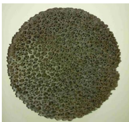
Figura A3| El absorbedor después del tratamiento e impregnación de \text{CeMnO}_4 .
