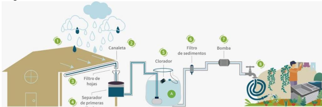
Figura 3. Componentes de un Sistema de Captación de Agua de Lluvia (Recuperado de SEDEMA, 2021).
