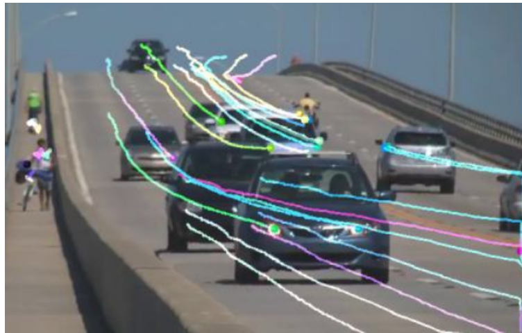
Figura 8-1: Ejemplo visual de utilizar Optical Flow en una imagen al mostrarse en ella el movimiento de objetos como los coches. Imagen obtenida de [39].
