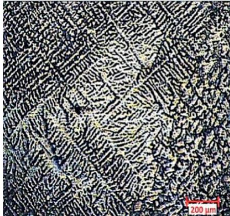
*Figura 12. Microestructura obtenida a 0.04% de Ti y 0.03% de Sr a temperatura de molde de 230°C.*
