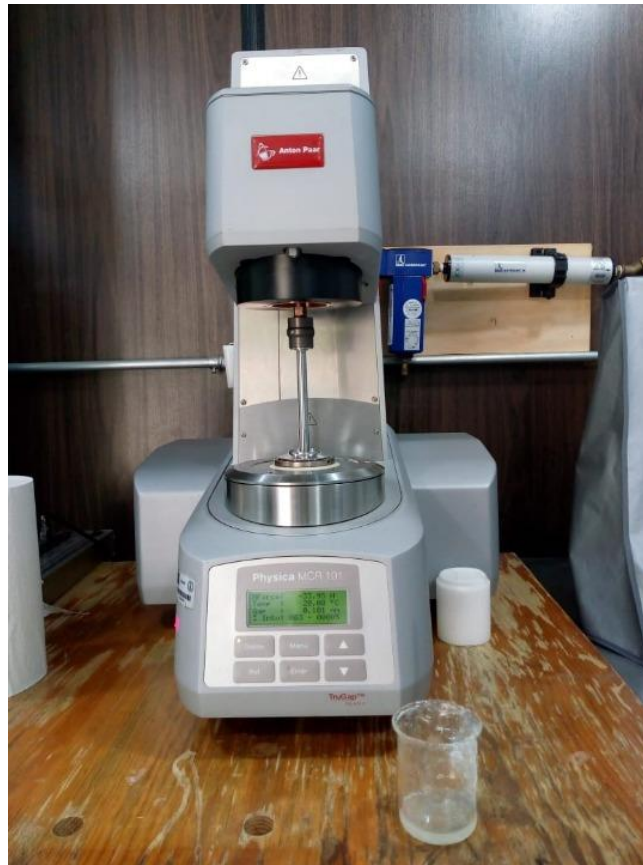
Figura 11. Reómetro Anton Paar MCR101 con configuración plato-plato.
