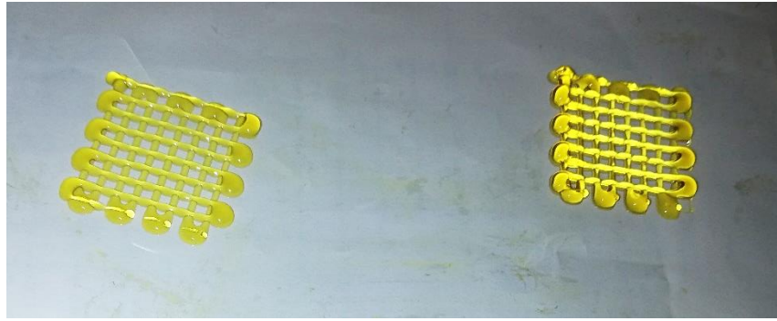
Figura 13. Andamios elaborados en el equipo 3D-Bioplotter.
