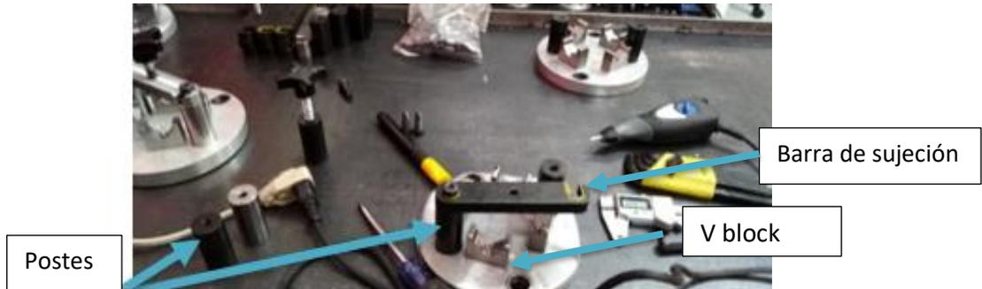
Figura 37. Herramientales para máquina *Robodrill*. Fuente: Elaboración propia
