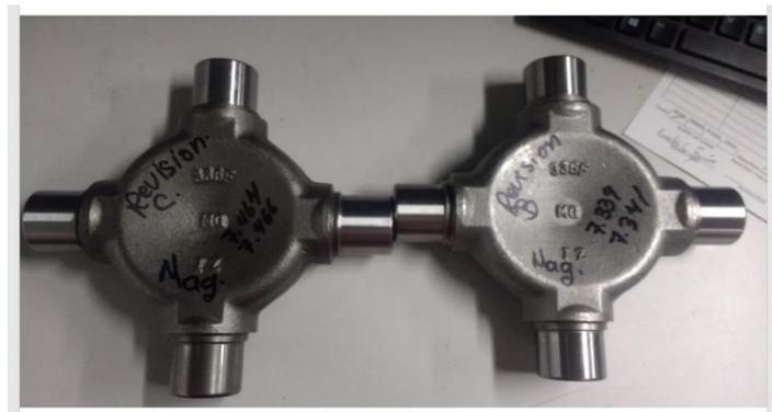
Figura 85. Crucetas probadas en torno Mazak con los nuevos herramientas. Fuente: Elaboración propia
