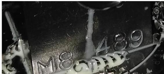
Figura 99. Marcado laser de número de parte y familia en herramienta de máq. Mazak. Fuente: Elaboración propia
