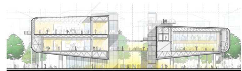
3.1 Corte transversal: se puede apreciar la estructura flotante del edificio, una conexión entre sus cuerpos y en la parte superior un mirador
