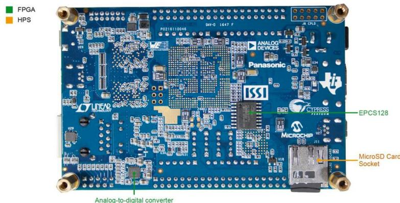
**Figura 3.7:** Vista superior e inferior de la tarjeta DE10-Nano-SoC [22]. Imagen tomada de “Data sheet tarjeta de desarrollo DE10-Nano”.
