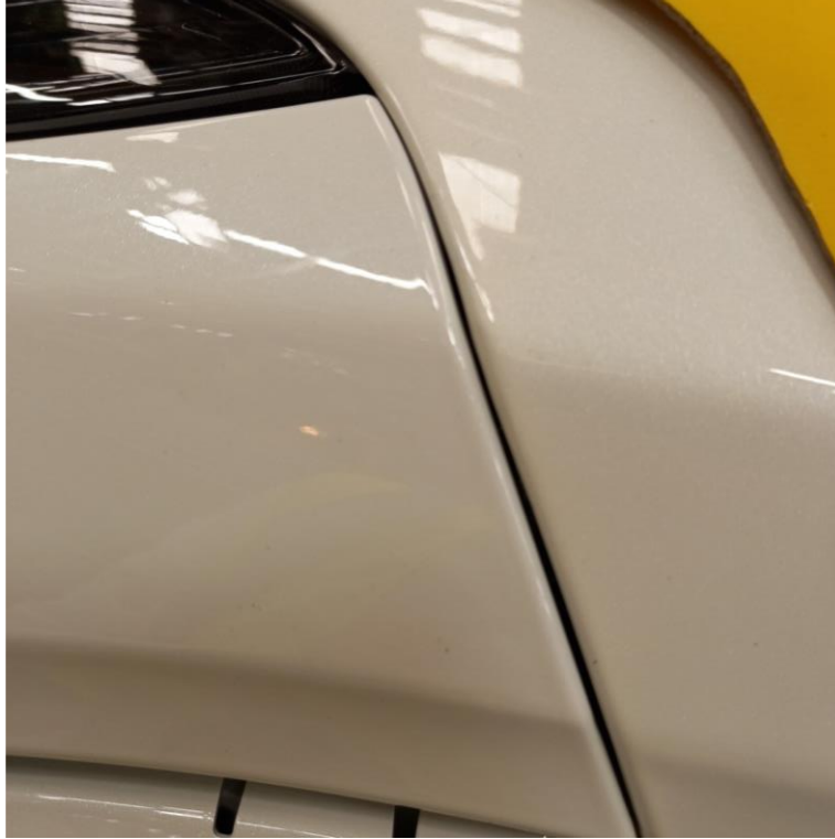
Ilustración 9. Condición de margen fuera de especificación en fascia frontal
