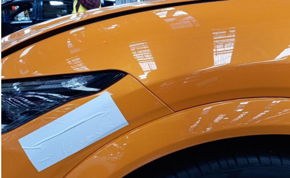
Ilustración 8. Vista izquierda de la zona de interacción entre fascia frontal y carrocería
