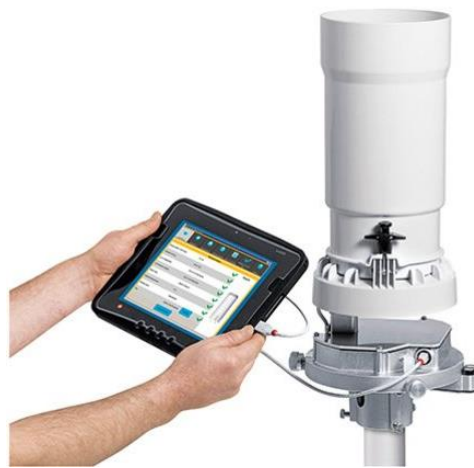
Ilustración 14 Pluviógrafo de pesaje OTT Pluvio² S mostrando la interface.
