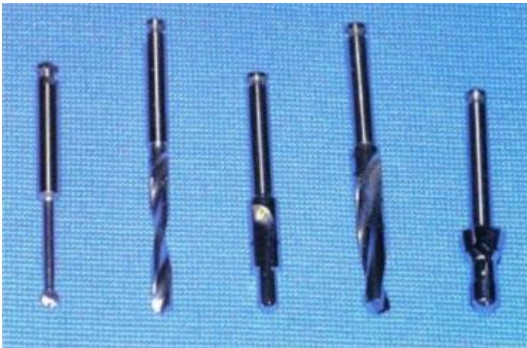
Fig. 1 En esta imagen podemos observar la secuencia de fresas para un implante
