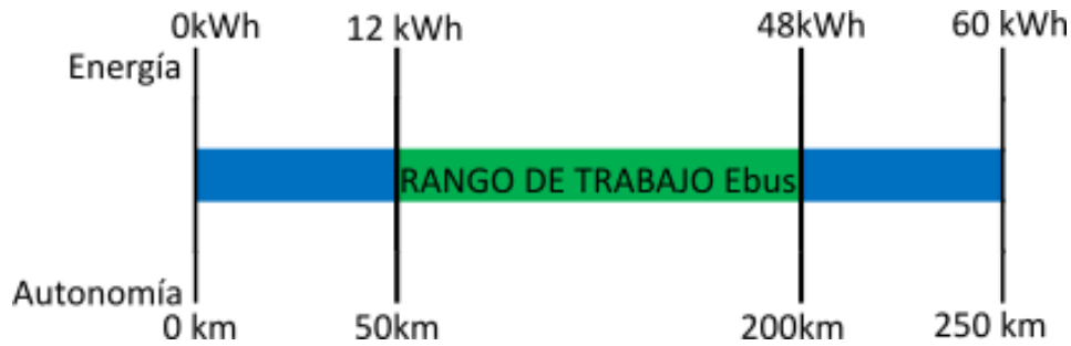
Figura 7.9: Rango de trabajo del camión eléctrico Ebus.
