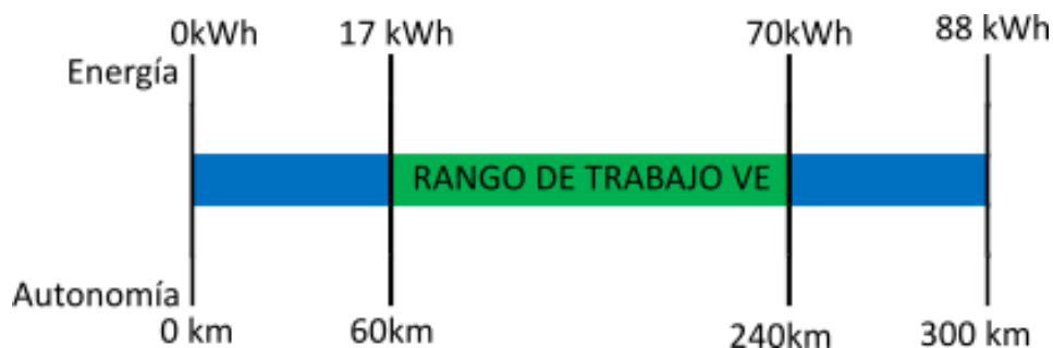
Figura 7.8: Rango de trabajo de la vagoneta eléctrica E5.
