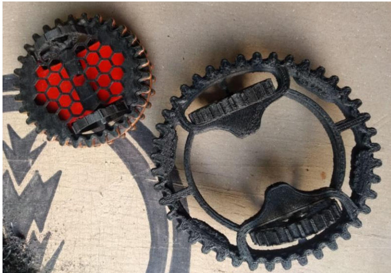
Figure 24 Comparación de tamaño entre la tercera y cuarta versión del mini rover originados por el nuevo tamaño de paneles y motores.
