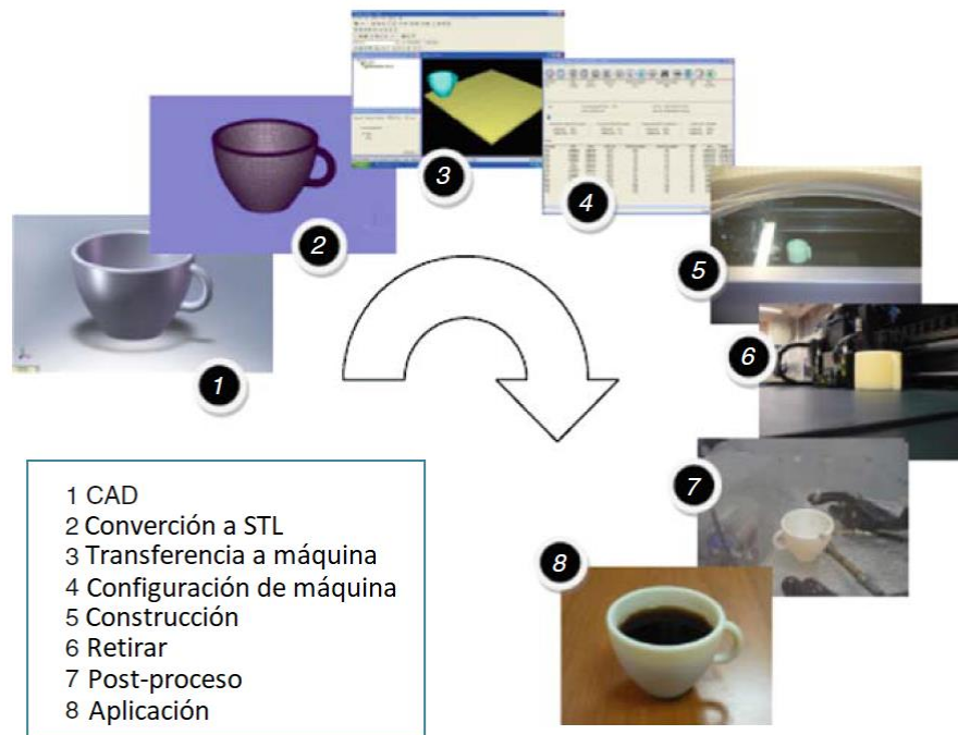
Figure 12 Proceso de creación de un objeto mediante manufactura aditiva [9].
