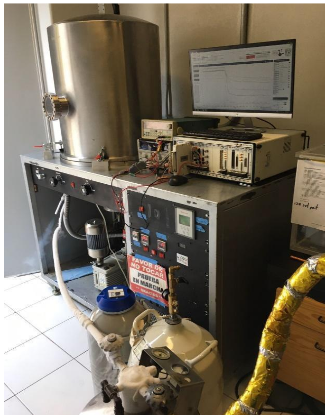
Figure 38 Campana de termo vacío donde se realizan las pruebas de validación en LINX.
