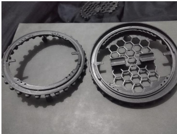
Figure 23 Segunda versión del cuerpo del mini rover (ABS).
