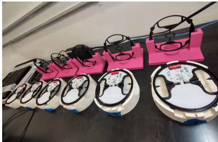
Figure 44 Preparación de los modelos de vuelo en la sala limpia de los mini rover para la misión COLMENA.
