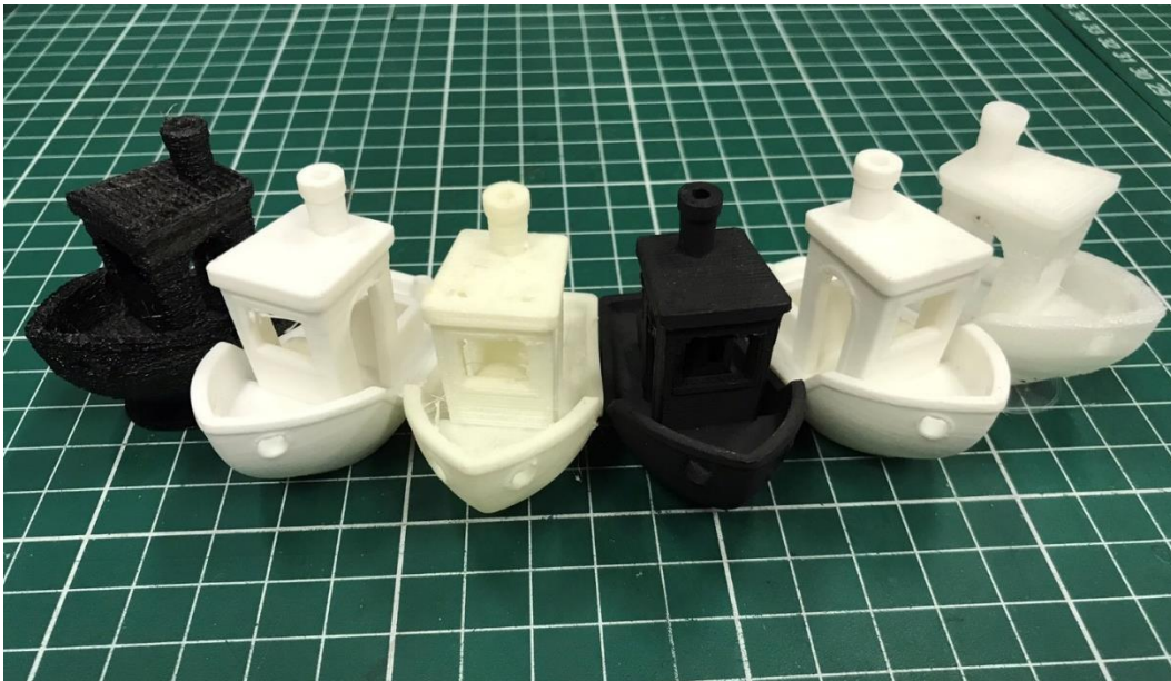
Figure 16 Prueba de impresión #3DBenchy con los diferentes materiales que se cuenta en LINX.
