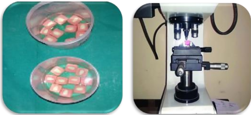
Figura 6. Muestras sumergidas en agua destilada (izquierda), prueba de microdureza en indentador (13).
