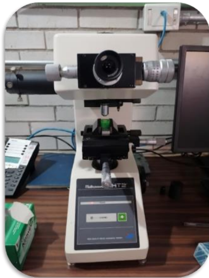
Figura 20. Durómetro de alta calidad MHT2 marca Matsuzawa. Fuente propia.
