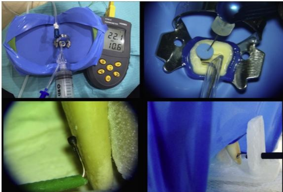
Figura 8. Modelo experimental utilizado para medir la reducción temperatura en las raíces de control y experimentales.
