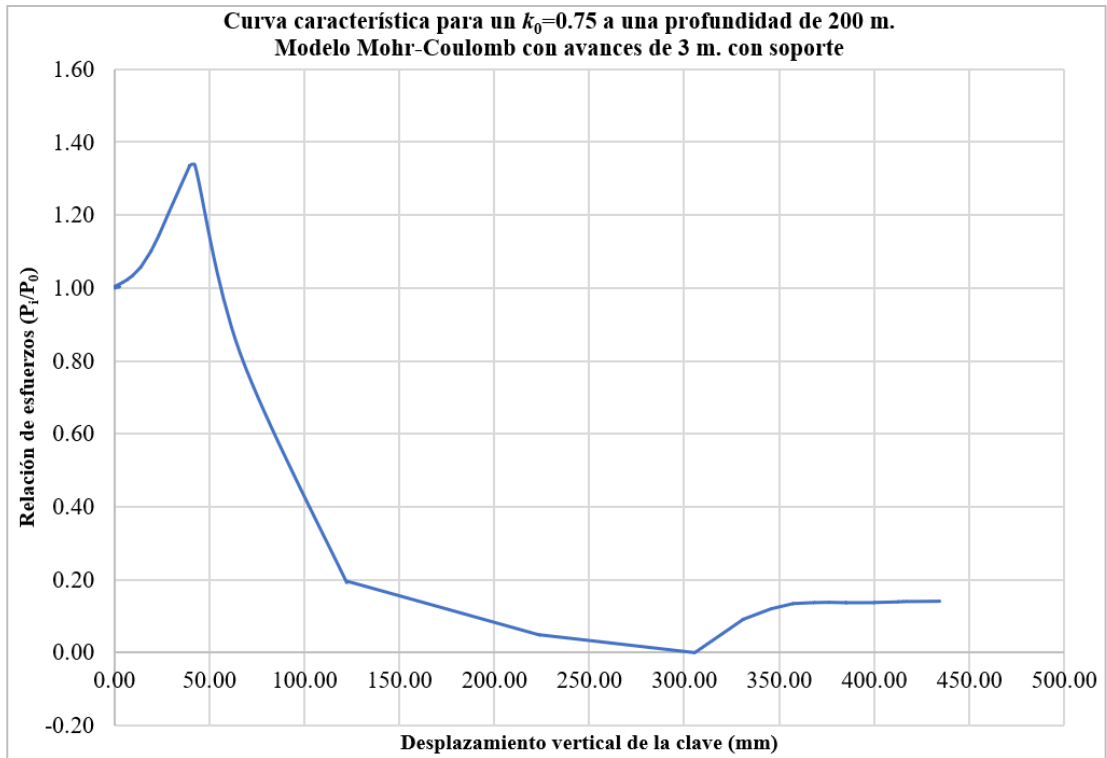
A. 62. Curva característica para un k_0=0.75 a una profundidad 200 m. Modelo Mohr-Coulomb con avances de 3 m. con soporte.
