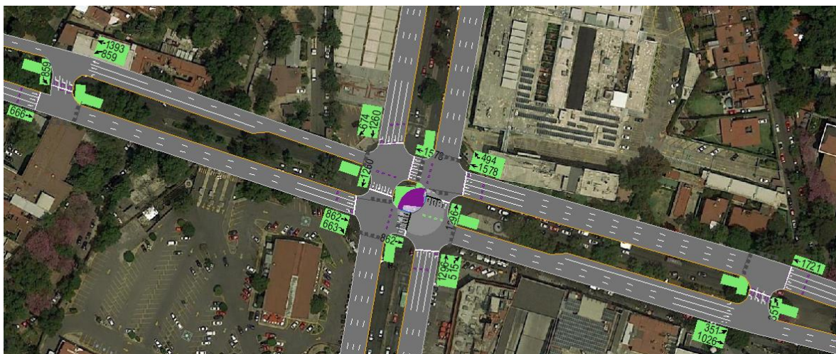
Captura del modelo de la intersección con la implementación de una MUT
