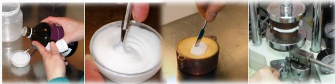
Figura 25. Realización de esclerótica con PMMA, prensado de la mufla. 42
