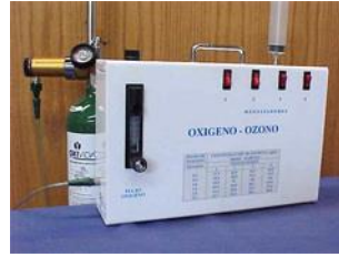
Figura 9. Generador de Ozono con tanque de oxígeno. https://ozonotab.weebly.com/uploads/1/2/8/3/12835757/348997519.jpg
