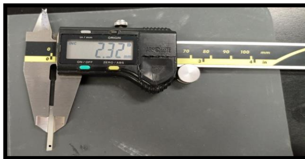
Imagen 19. Vernier digital, midiendo la base de la muestra (Fuente propia).
