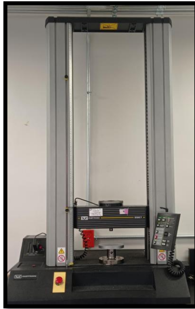
Imagen 20. Máquina universal de pruebas INSTRON (Fuente propia).
