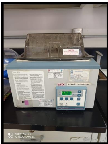
Imagen 11 y 12. Baño de estabilidad Polyscience, Usa (Fuente propia)
