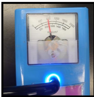
Imagen 1. Medición de intensidad de la Lámpara Bluephase N de Ivoclar™ en radiómetro Led (Demetron, USA). (Fuente propia)
