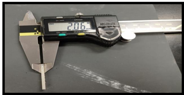
Imagen 18. Vernier digital, midiendo el ancho de la muestra (Fuente propia)
