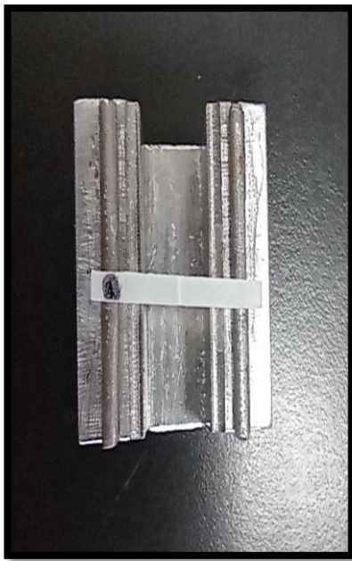
Imagen 21 y 22. Colocación de la muestra sobre la base de la máquina INSTRON para comenzar la carga. (Fuente propia).
