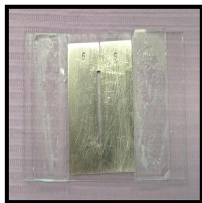
Imagen 3. Molde metálico sobre cinta mylar y loseta de vidrio (Fuente propia).
