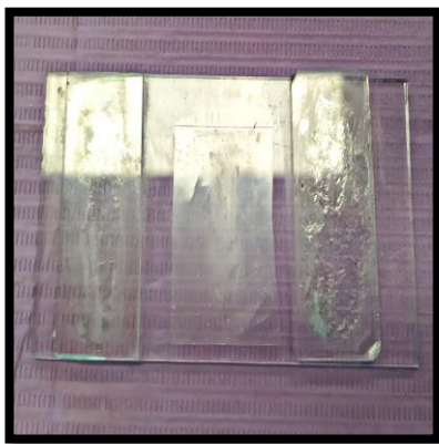
Imagen 2. Colocación de cinta mylar sobre la loseta de vidrio (Fuente propia).
