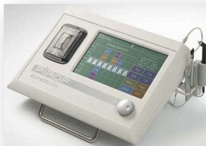
Fig.31 Biometro PIROP de medición ultrasónica.<sup>59</sup>
