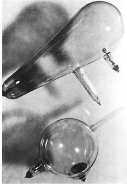
FIGURA 1-3 Tubos de Hittorf-Crookes usados por Roentgen para descubrir los rayos X. (De Goaz PW, White SC: Radiología oral y principios de la interpretación , ed 2, St. Louis, 1987, Mosby.)
