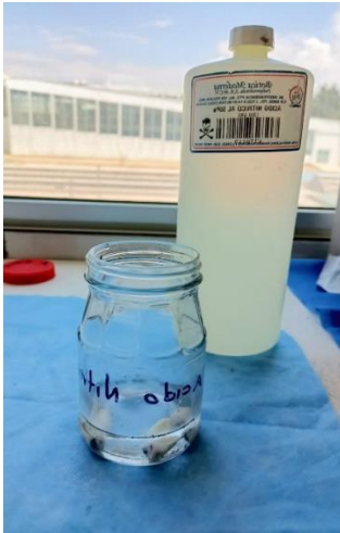
a ácido nítrico para diluir, b dilución del ácido e inmersión de las muestras.
