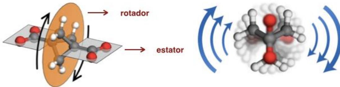
Figura 1.2 Esquematación de un rotor molecular con sus componentes indicados y movimiento dinámico rotacional.
