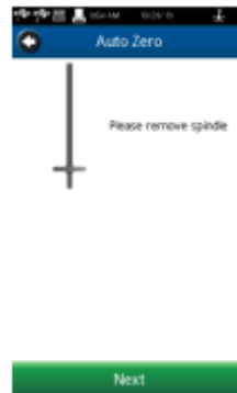
Figura 3.1: Pantalla del calibrado auto-cero del reómetro DVnextLV de la marca Brookfield (AMETEK-Brookfield, 2019).
