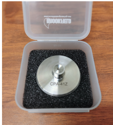
Figura 3.2: Cono CPA-41Z de la marca Brookfield colocado en el reómetro para el estudio de la viscosidad.
