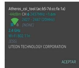
A22. Tarjeta de red QCWB335 Mac ID ac:b5:7d:cc:fa:1a en modo AP, en funcionamiento.
