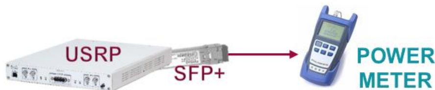
Figura 4.3 Diagrama de conexiones para medir potencia en los SFP+ equipados en los USRP
