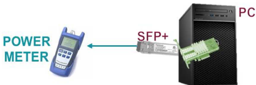
Figura 5.2 Diagrama de conexiones que se empleó para determinar la potencia de referencia.
