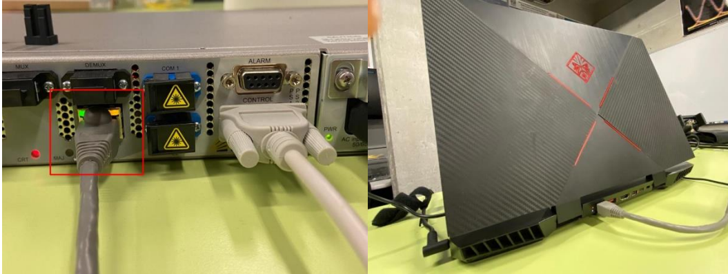
Figura A.9 Conexiones de PC al PL-1000TE a través del puerto LAN.
