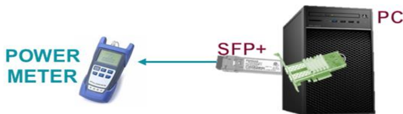
Figura 4.7 Medición de potencia en los SFP+ conectados a las PC
