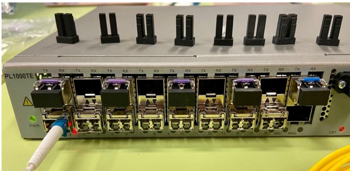
Figura 4.6 Puerto del PL-1000TE seleccionado para medir todos los SFP+ que operan a 1310.
