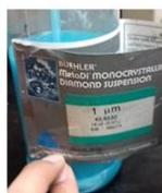
Figura 11. Suspensión de diamante 1 µm, marca BUEHLER usada en el pulido de las placas de Ti.
