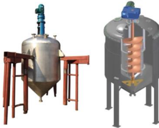
Figura 239. Reactor de saponificación
