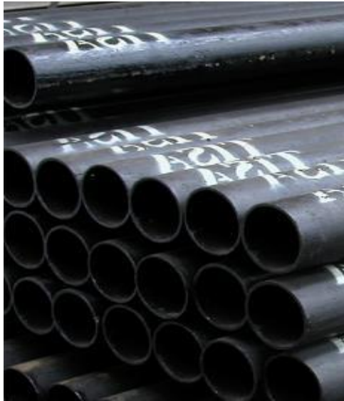
Figura 40. Tubería de hierro negro
