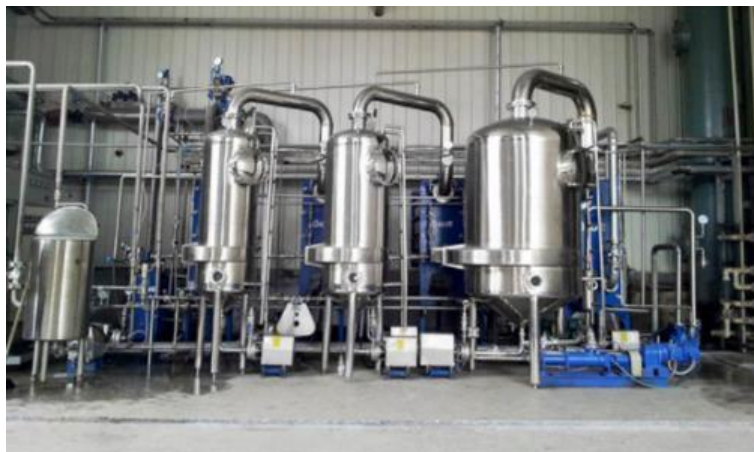
Figura 86. Evaporador de efecto múltiple
