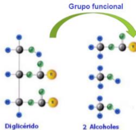
Figura 116. Etapa 2 de la transesterificación: formación de un diglicérido
