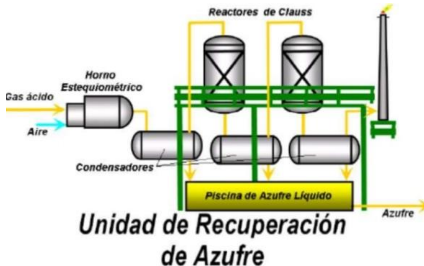
Figura 9. Proceso Claus de recuperación de azufre a partir de ácido sulfhídrico
