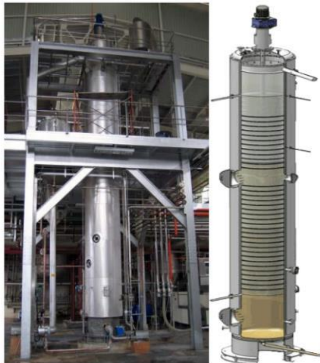
Figura 240. Torre de lavado para el proceso de saponificación (Flores, 2017).
