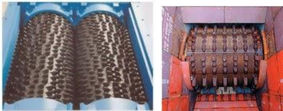
Figura 175. a) Triturador de rodillos dentados, b) Triturador con rodillo único
