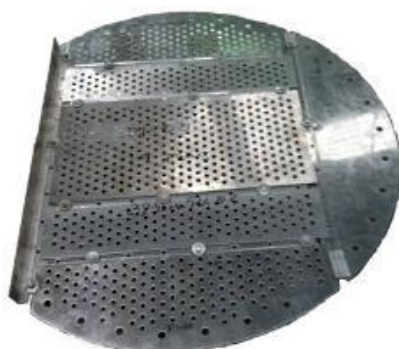
Figura 146. Plato perforado para columna usada en extracción líquido-líquido
