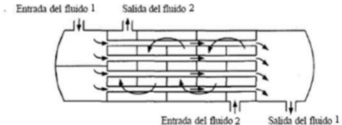
Figura 161. Esquema de funcionamiento de un intercambiador de tubos y coraza
