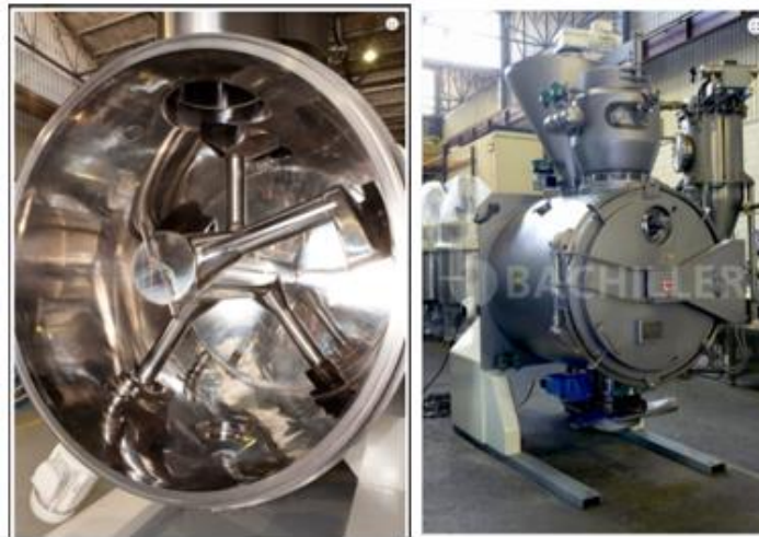
Figura 101. Secador al vacío horizontal de paletas (Bachiller, 2020).
