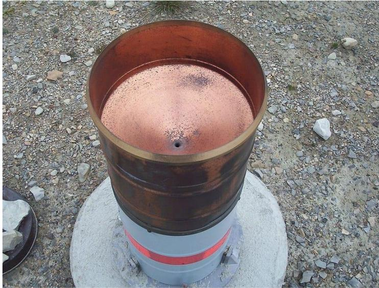
Figura 26. Pluviometro de balanza Fuente: meteorologiaenred.com
