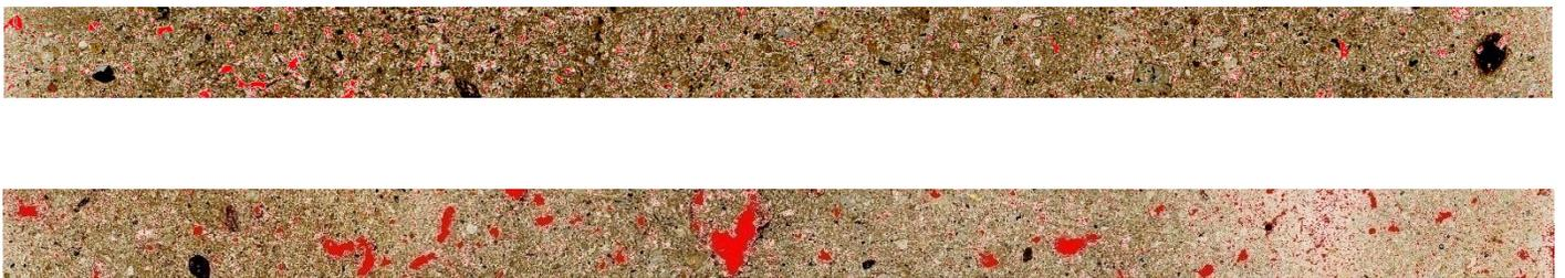
Figura 12. Ejemplo del análisis micromorfométrico aplicado al porcentaje de espacio poroso de las muestras. Fotografía correspondiente a la muestra E6, arriba parte superior de la muestra, abajo parte inferior. Nótese la diferencia del espacio poroso.
