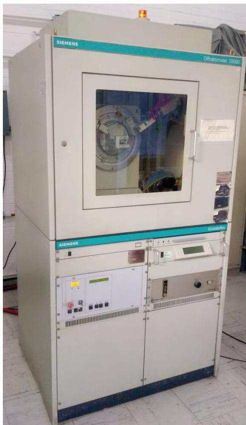
Figura 24. Difractómetro Siemens D-5000 del Instituto de Investigaciones en Materiales de la UNAM.
