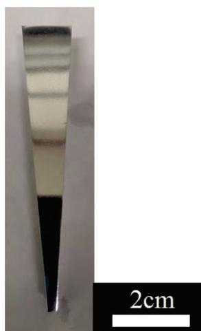
Figura 27. Lingotes en forma de cuña donde se observa el acabado espejo obtenido con la preparación metalográfica.
