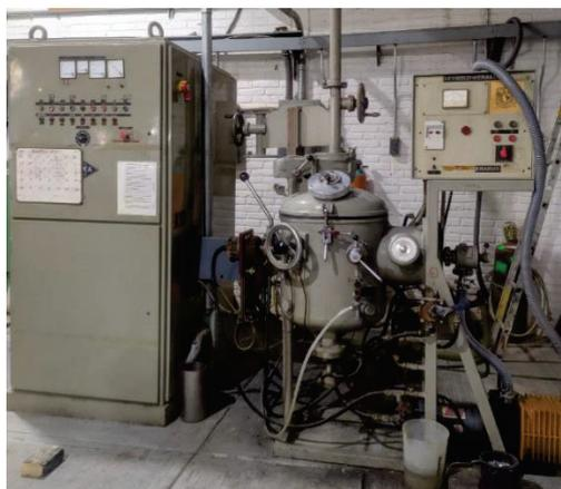
Figura 21. Horno de inducción con cámara de vacío del Instituto de Investigaciones en Materiales.
