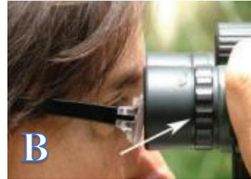
**Paso 2.** En caso de no usar anteojos (imagen A), se pueden extender los anillos oculares para que las pestañas no toquen el ocular (lente). En caso de usar anteojos (imagen B), no es necesario extender los anillos oculares.
