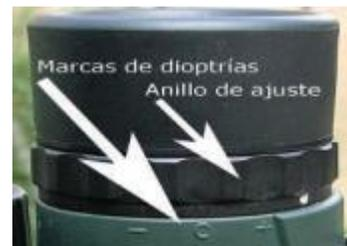
**Paso 5.** Encuadra un objeto y observa únicamente por el ocular donde se encuentra la marca de dioptrías, para después mover el anillo de ajuste hacia la izquierda o derecha hasta que la imagen sea clara.
