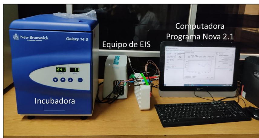
Figura 18. Sistema utilizado en las pruebas de impedancia de los andamios.
