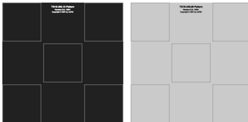
Figura 10.- Patrones TG18-UNL10 (derecha) y TG18-UNL80 (izquierda).
