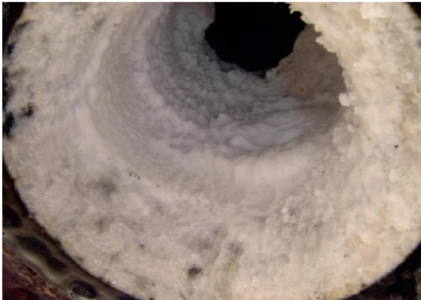
Figura 1.5: Incrustación de salmuera con alto contenido de sílice en una de las tuberías del intercambiador de calor [21]
